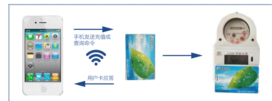
图2NFC 技术在智能水表中的应用
